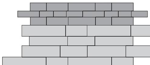
⚠ Le calepinage est indicatif. En fonction de vos goûts, une pose aléatoire en utilisant les rangs complets des palettes, et en évitant les joints croisés, pourrait s'avérer être une solution alternative
