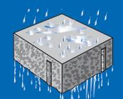
**RDP** : Revêtement **D**rainant **P**oreux en concassé fin : perméable sur toute son épaisseur, permet l'absorption et évacuation de l'eau dans le sous sol.
