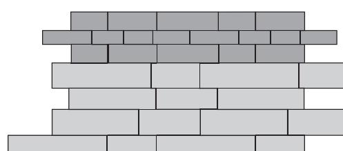
**⚠** Le calepinage est indicatif. En fonction de vos goûts, une pose aléatoire en utilisant les rangs complets des palettes, et en évitant les joints croisés, pourrait s'avérer être une solution alternative
