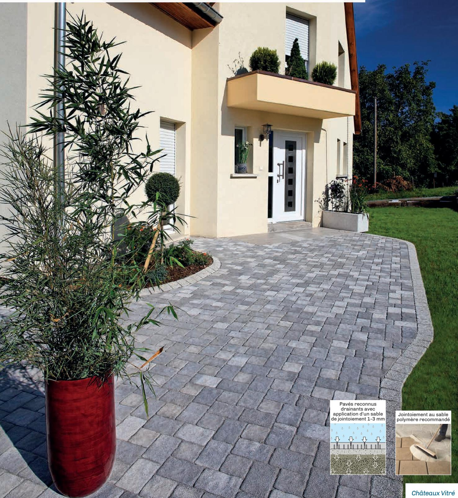
Pavés reconnus drainants avec application d'un sable de jointoiement 1-3 mm
