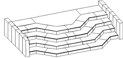
Bei Klassik und Modernit / Sierra Stufen sind die lateralen Kanten abgefräst
