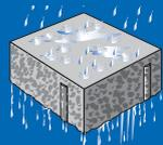
**RDP : Revêtement Drainant Poreux en concassé fin** : perméable sur toute son épaisseur, permet l'absorption et évacuation de l'eau dans le sous sol.
