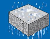
**RDP** : Revêtement **D**rainant **P**oreux en concassé fin : perméable sur toute son épaisseur, permet l'absorption et évacuation de l'eau dans le sous sol.
