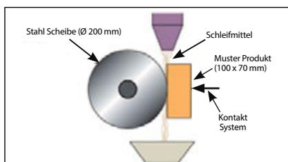
Abriebwiderstand nach europäischer Norm NF EN 1338 (für Beläge, die dem Fahrzeugverkehr ausgesetzt sind).
