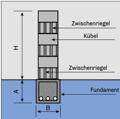
Als Böschungsbefestigung inklusive Zwischenriegel. Variabler Versatz bis maximal 25 cm.
