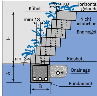
Als Böschungsbefestigung inklusive Zwischenriegel. Größtmöglicher Versatz (Beispiel mit Drainage).
