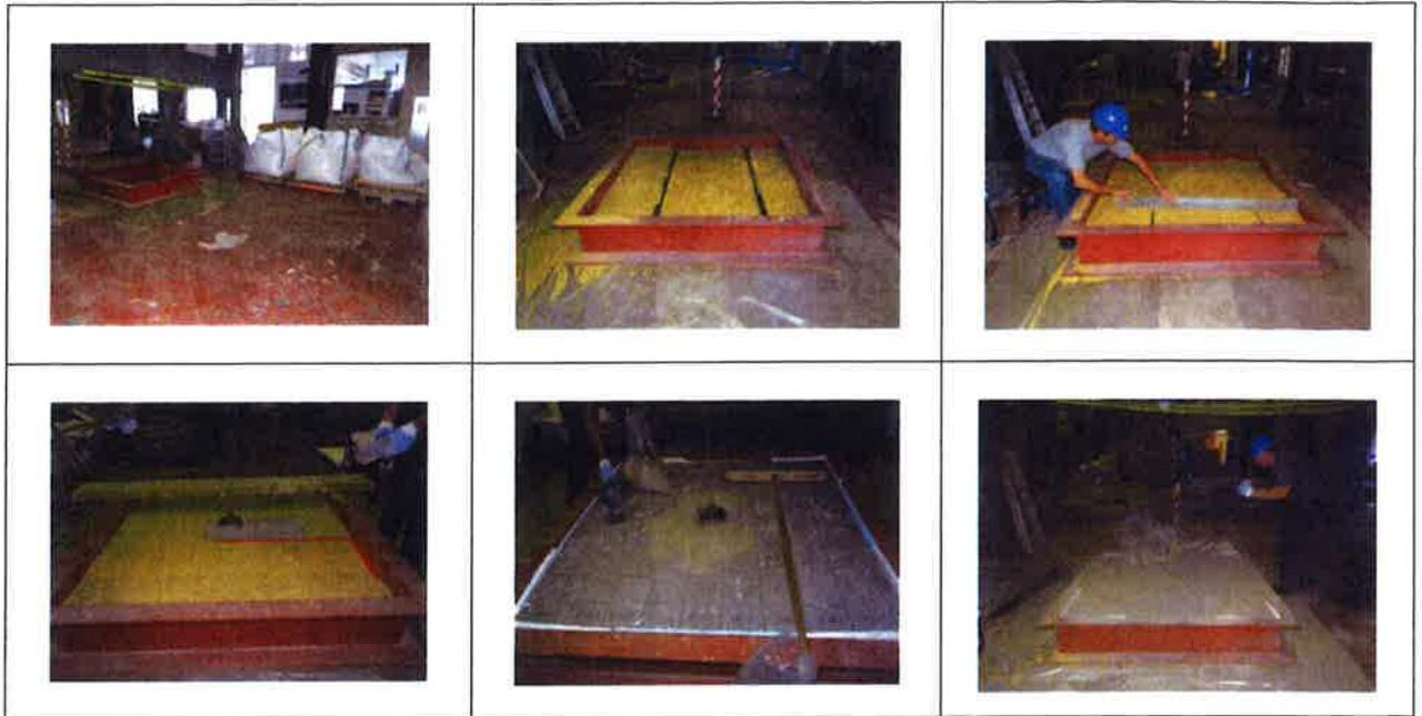
Figure 2 – Photographies de la réalisation des corps d'épreuve
