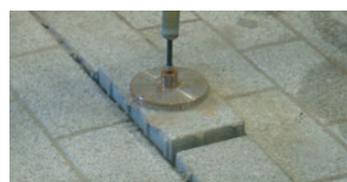
test d'arrachement 8 fois supérieur au pavé traditionnel en arrachement
