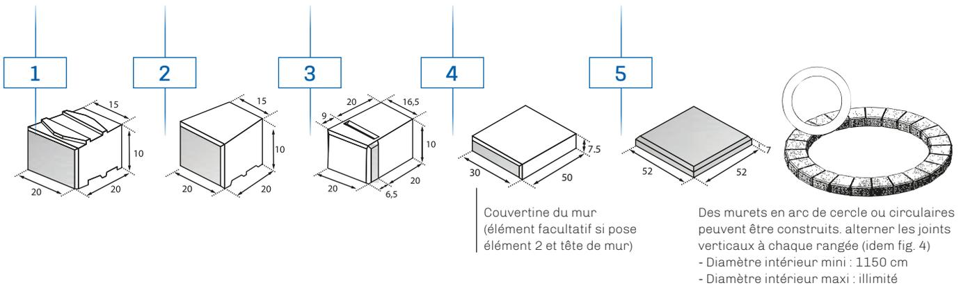
1 - Pour un muret sans couvertine, utiliser en tête de muret les éléments 2
