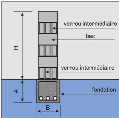
Mur de soutènement. Pose en escalier avec ou sans verrous. Décalage variable, maxi 25 cm - mini 13 cm.
