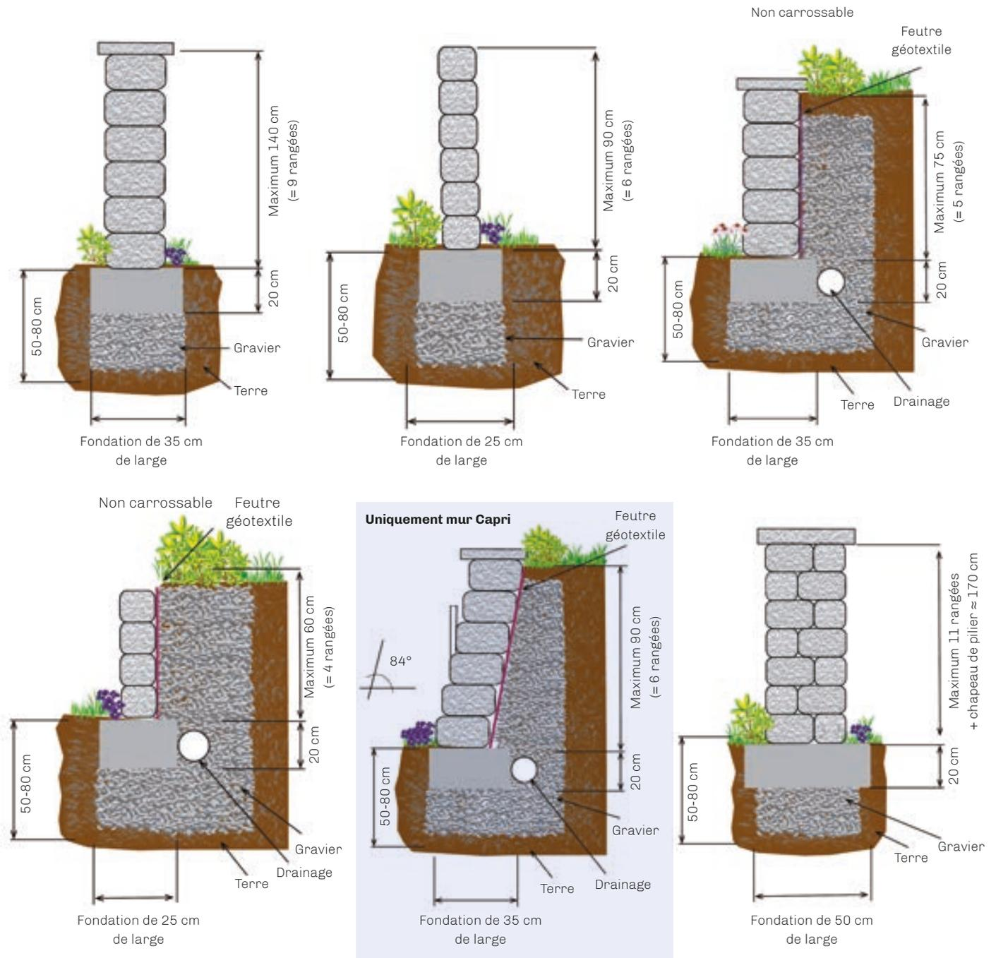
En cas d'assemblage pour la réalisation d'un mur de soutènement, la hauteur de ce dernier doit être inférieure ou égale à 1 m et le mur correspondant doit être utilisé pour des charges de faible importance (talus horizontal et surcharge faible).
