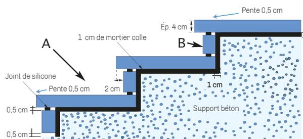
Un parfait alignement de l'arête supérieure de la contremarche lors de la pose sera possible. De même, le joint va permettre de stopper l'épandage en surface des eaux de ruissellement chargées de chaux d'efflorescence cheminant entre les éléments et leur support.
