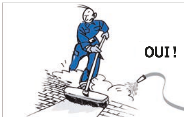
Sablage de finition : en cas d'utilisation de sable polymère, se reporter obligatoirement aux conseils de pose du fabricant Techniseal.
