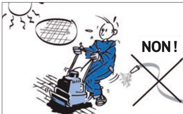
Compactage : à l'aide d'une plaque vibrante munie d'une lame caoutchouc.
