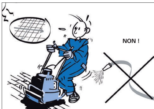
Compactage : à l'aide d'une plaque vibrante munie d'une lame caoutchouc.
