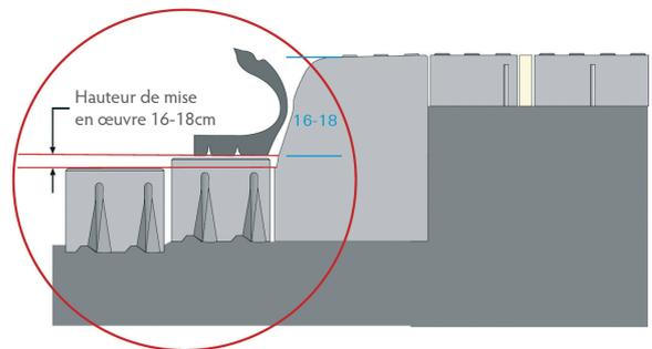
Les QUAÏ DE BUS BARRIFLEX permettent une mise en œuvre sur différentes hauteurs, sans pour autant influencer les avantages énumérés.
